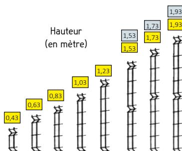
Fil acier galvanisé suivant EN 10244-2, 50 gr ZN / m<sup>2</sup>. Résistance à la traction du fil 60 à 70 kg mm<sup>2</sup>, avec résistance au cisaillement des soudures supérieure à 50 % de cette valeur.
