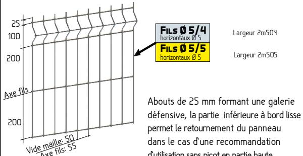
Abouts de 25 mm formant une galerie défensive, la partie inférieure à bord lisse permet le retour du panneau dans le cas d'une recommandation d'utilisation sans picot en partie haute.
